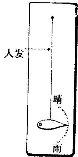
这里介绍一种自制毛发湿度计的简便方法：拿一根长26厘米（约8寸）的头发，放在碱水里洗去头发上的油质，经过清水漂洗后，把它阴干，然后把头发的一端固定在一块木板的上方，另一端固定在铁片做成的指针当中，指针一端钉在木板上，但指针可以上下移动，在指针尖端的一边画一些刻度，做成后就可以使用。在一般的情况下，当指针上移，说明头发中纤维组织收缩，空气中水汽减少，预示天气晴朗；指针下移，说明空气中水汽增多，预示天气要转阴雨。
