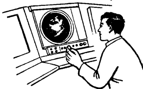
雷雨或暴雨。假使在甲地已经有了雷雨，离甲地几百公里的地方设立的雷达仪器的荧光屏上，就可以看到一块块边缘不规则的亮斑或亮条，这就是雷雨的象。荧光屏上划有一些线条，指示出雷雨离雷达有多远。如果雨下得很大，反映在屏上的亮斑或亮条也就很亮。只要我们相隔一定的时间，多观察几次，就可计算出雷雨的移动方向和移动速度。这样就能知道，再过几小时，或者几十分钟，什么强度的雷雨将要来临了。暴雨和一般雨的强度上相差很大，通过荧光屏的亮斑，是可以分辨出来的。
