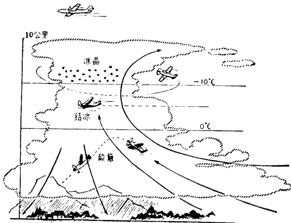
高度越高，温度越低。因此当飞机穿入云中时，如果这时云中的温度在摄氏零度以下，飞机的机翼遇到云中过冷水滴的撞击，有时会形成冻结的冰瘤（飞行员把它叫作“飞机结冰”），影响飞机的飞行。
