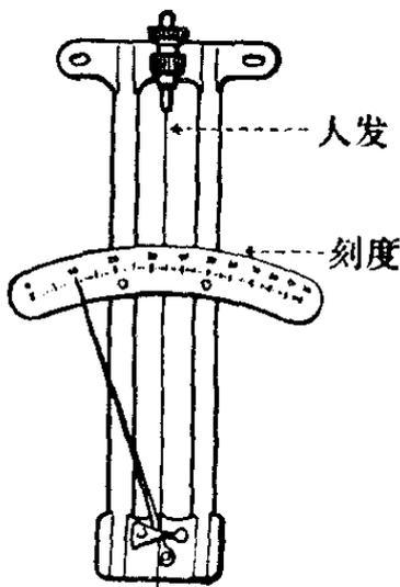
是由于这些纤维组织有许多毛细孔，空气湿度大时，毛细孔内的水分增加，使纤维组织伸长，空气湿度减小时，使纤维组织发生收缩。根据纤维组织伸缩的特点，人们制成了毛发湿度计。因为头发也是纤维结构，经过加工处理后，灵敏度高，性能较稳定，而且制造方便。
