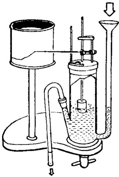
一弯曲的杠杆，杆端接一支笔尖，随着浮筒的上下可以上下移动。时钟装在一只圆筒内，随着时钟的走动，圆筒就转动了。在圆筒的表面上附有一张以时间和雨量为坐标的自记纸，笔尖接触自记纸。当盛水筒内水量增加时，浮筒上升，笔尖向上移动，自记纸上划出了线条。随着时钟的走动，雨量的增加，所划的线就成一条曲线。如果在某一瞬息间雨量很大，线条就表示出直线上升，气象台工作人员从自记纸上的曲线变化，就可以读出任何时刻的雨量。
